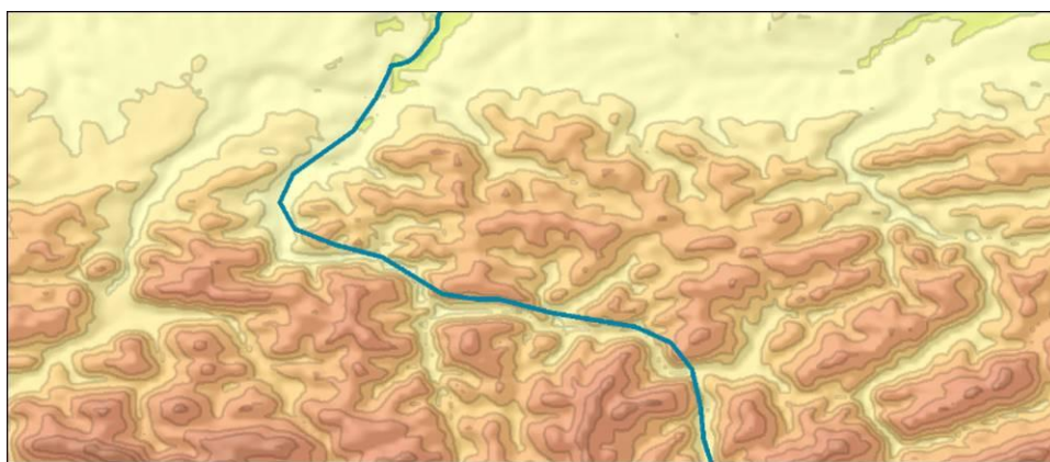
Рис. 1. Несоответствие цифровой модели рельефа и объекта гидрографии
